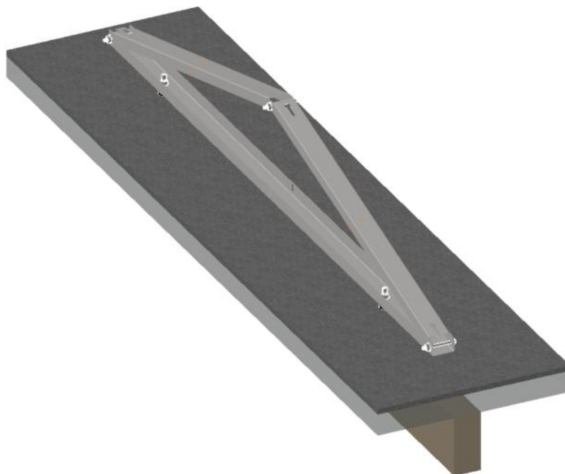
Rys. Widok trójkąta zamontowanego na śrubach dwugwintowych
