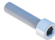
Innensechskantschraube M8X35 DIN912 A2
