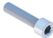
Śruba imbusowa M8x35 DIN912 A2
