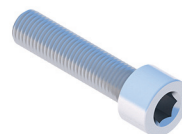
Śruba imbusowa M8X35 DIN912 A2
