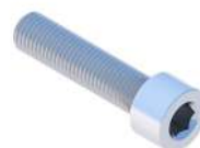
Śruba imbusowa M8X100 DIN912 A2
