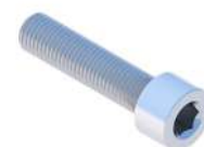
Śruba imbusowa M8X100 DIN912 A2
