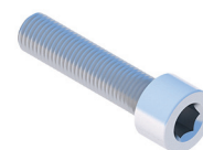
Śruba imbusowa M8X35 DIN912 A2
