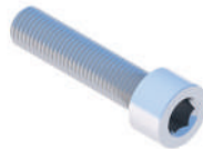
Innensechskantschraube M8X35 DIN912 A2
