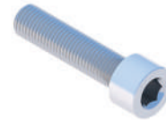
Innensechskantschraube M8X35 DIN912 A2
