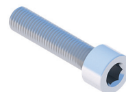
Śruba imbusowa M8x35 DIN912 A2
