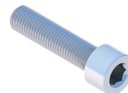
Śruba imbusowa M8X35 DIN912 A2
