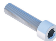
Śruba imbusowa M8X35 DIN912 A2
