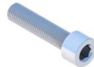
Innensechskantschraube M8X35 DIN912 A2
