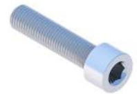
Innensechskantschraube M8X35 DIN912 A2
