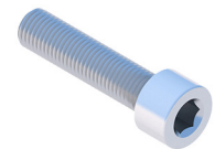
Innensechskantschraube M8X35 DIN912 A2
