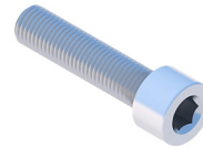
Innensechskantschraube M8X35 DIN912 A2
