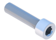
Innensechskantschraube M8X35 DIN912 A2
