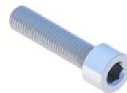
Innensechskantschraube M8X35 DIN912 A2
