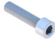
Innensechskantschraube M8X35 DIN912 A2
