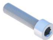
Innensechskantschraube M8X35 DIN912 A2
