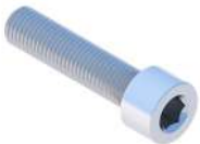
Innensechskantschraube M8X100 DIN912 A2 SIM8X100A2
