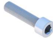
Innensechskantschraube M8X35 DIN912 A2
