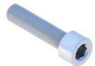
Innensechskantschraube M8X35 DIN912 A2
