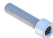
Śruba imbusowa M8X35 DIN912 A2
