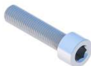
Śruba imbusowa M8X35 DIN912 A2
