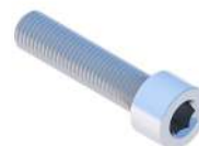
Śruba imbusowa M8X35 DIN912 A2
