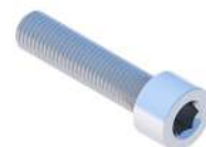
Śruba imbusowa M8X35 DIN912 A2
