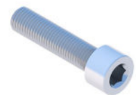
Śruba imbusowa M8X35 DIN912 A2
