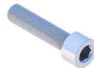
Śruba imbusowa M8X35 DIN912 A2
